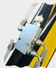
Гидрозамок на цилиндре стрелы. Обеспечивает безопасность в любом положении стрелы, также - не требует участия оператора в фиксации стрелы.
