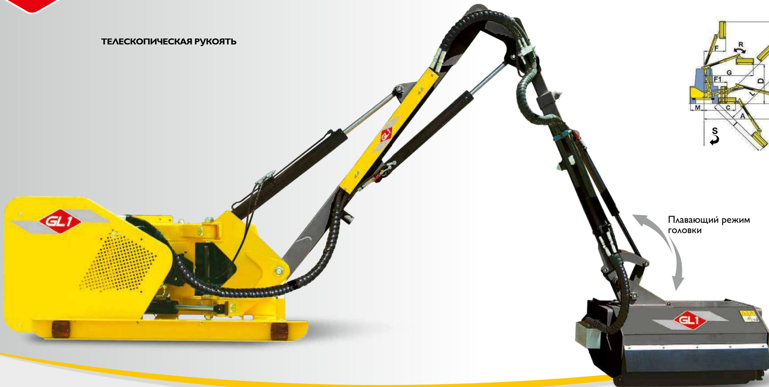
Плавающий режим головки
