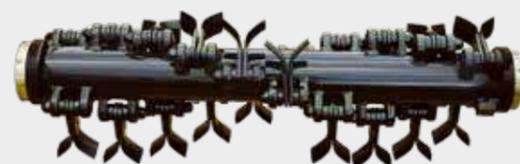
Ротор режущей головки DS130/5 имеет спиральное размещение резцедержателей. Реверсивное вращение для эффективного измельчения как травы, так и ккустарников
