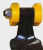
Опорный ролик диаметром 140 мм с защищенной системой "лабиринт" подшипниками
