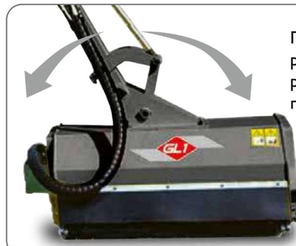
Плавающий режим режущей головки
